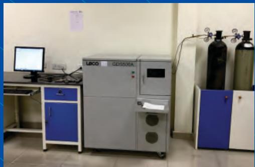
Спектрометр тлеющего разряда Leco
