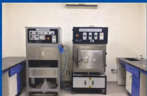
Стенды для испытаний сухим абразивом
