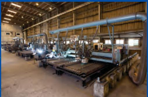
Комплекс наплавочных машин
