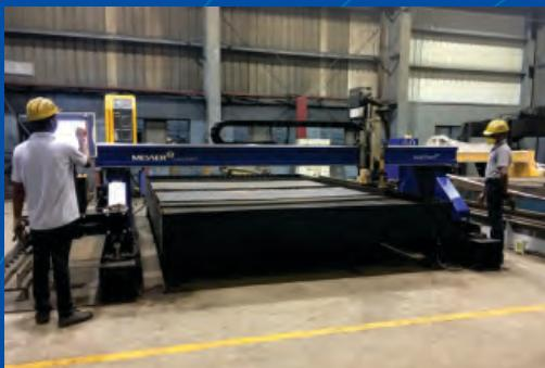
Плазменная резка на станке с ЧПУ
