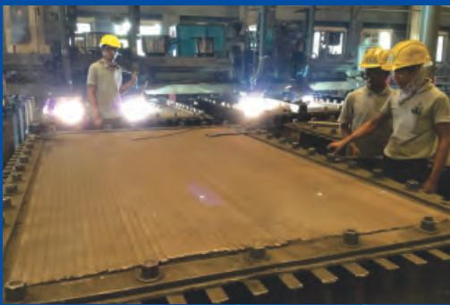
Процесс производства износостойких покрытий
